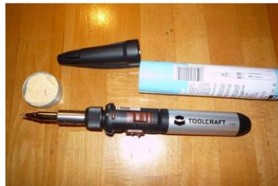
Für den mobilen Einsatz gibt es LötKolben, die unabhängig von der Stromversorgung (z.B. im Außenbereich) betrieben werden können, da sie mit Feuerzeuggas betrieben werden. Kein Gerät zum Einsatz im NwT-Raum! Kann aber als mobiles „rettendes“ Werkzeug hilfreich sein. Einsatz durch Lehrkraft oder nur unter direkter Aufsicht durch die Lehrkraft.
